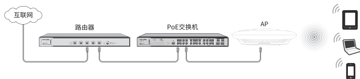
图4-1 典型应用拓扑图-有线组网
